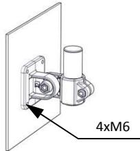
Abb. 2 Anbindung an eine Profilstütze
