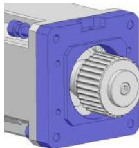
6. Centrer l'adaptateur sur la bride du moteur et visser.
