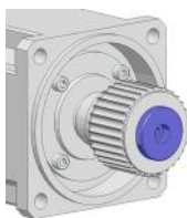
4. Inserire il disco nel disco dentato.
