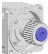
4. Colocar el disco en el disco dentado.
