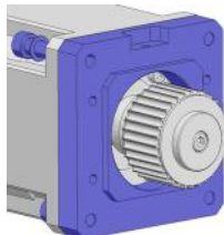
6. Centrare l'adattatore sulla flangia motore e avvitare.
