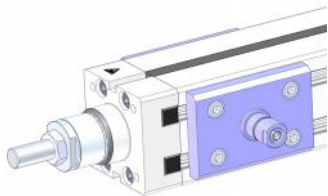
Fig. 5 : Fixation par tourillons pivotants
