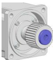
4. Scheibe in die Zahnscheibe einsetzen.
