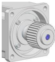
5. Visser la rondelle avec la vis CHc dans le tourillon d'entraînement.
