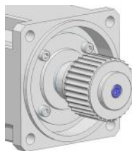
5. Enroscar el disco con el tornillo del cilindro al pivote de accionamiento.
